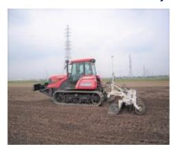
使用例 ・・・GPSレベラー、GPS代掻き、GPS明渠・溝切、GPSプラウ
