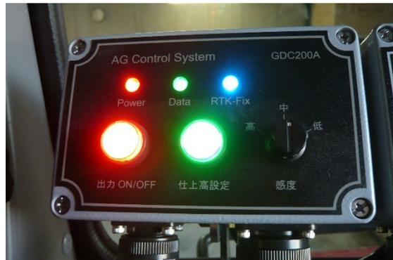
上記 3 個の LED が正常な状態なり、レベラー(作業機)の高さをトラクタのポジコンで仕上げたい高さに合わせた後、仕上高設定スイッチを押すとスイッチが緑色で 5 秒間点滅し、その後緑色点灯(左側の写真)に変わり、仕上高が設定された事を示します。さらに出力 ON/OFF スwitchを押すとスイッチが赤色に点灯しコントローラーに GPS の高さ信号を出力している状態(右側の写真)になります。
